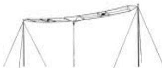
Дипольная антенна бегущей волны. Имеет круговую диаграмму направленности и хорошо работает на расстояниях от очень коротких до средних. Разработана в трёх моделях для покрытия КВ спектра, работает до 1КВт (пик). Диаграмма направленности практически круговая, однако, при работе на близкие расстояния антенну следует ориентировать перпендикулярно к направлению на абонента.
