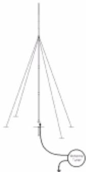
Базовая штыревая антенна высотой 9.5 м используется совместно с антенным тюнером. Устанавливается вертикально на земле или металлической крыше.
