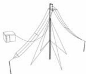
Антенна TFD 411 это двух проволочная дипольная антенна специально разработана для использования в широкой полосе рабочих частот. Предназначена для 100% тяжелых условий работы, как в голосовом режиме, так и при передаче данных по номинальной выходной мощности.
