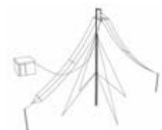
Комплект, в который входят Широкополосная Дипольная Антенна TFD 411 и мачта обеспечит Вам легкое и быстрое развертывание КВ системы связи с выходной мощностью 125 Вт. Комплекты поставляются с различными типами отделки поверхности мачты. Комплект подходит для установки в конфигурации перевернутой "V" тем самым обеспечивается минимальная площадь для установки. Пользователи получают решение надежной КВ радиосвязи на средние расстояния.
